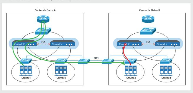
Cada centro de datos ejecuta un par de firewall activos para manejar la seguridad de los datos y servir como una reserva en standby el uno para el otro, en caso de que uno fallara.
